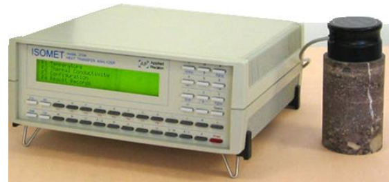
Figure 8: Mesure de la conductivité thermique par le dispositif ISOMET 2104, utilisant une surface chauffante.
